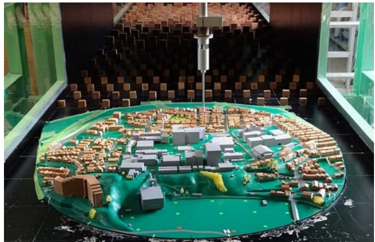
東京工芸大学厚木キャンパスを対象としたガス拡散の風洞模型実
